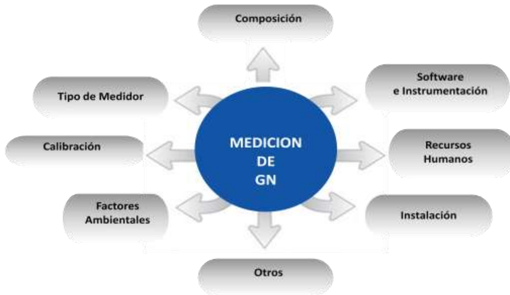
Figura 1 Factores que afectan una medición
