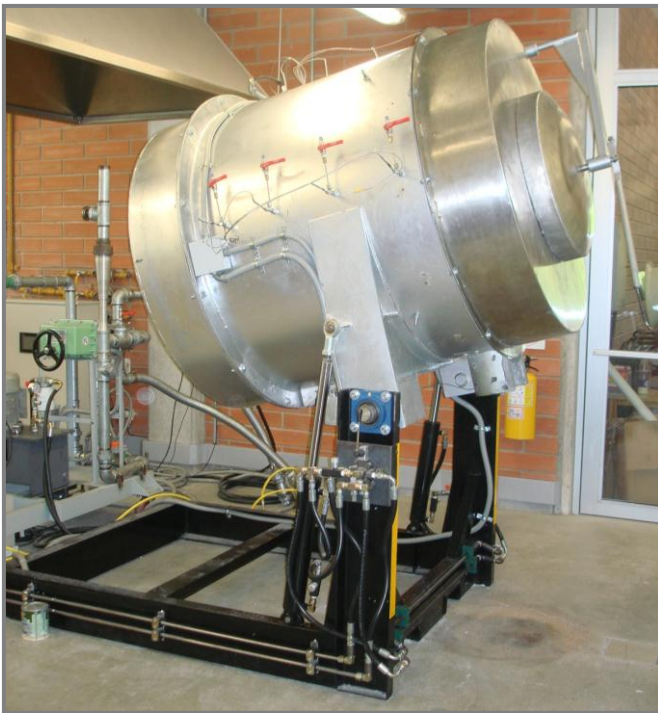
Horno Autoregenerativo con volteo hidráulico.
